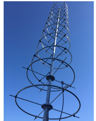
Una antena VHF mejorada capaz de soportar tanto las frecuencias VHF1 como VHF2. Créditos: NASA
